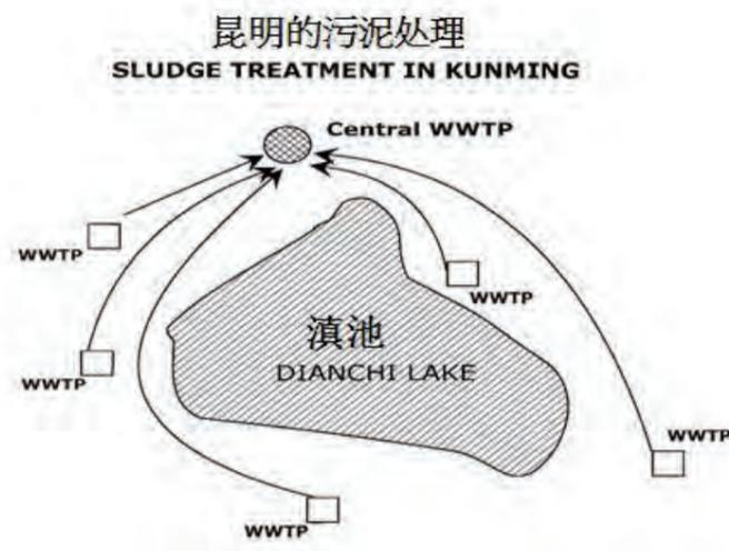
考虑位于昆明的业绩，设计为污泥中央处理厂。污泥由周边的5个污水厂经脱水后送往中央处理，处理量为100吨干泥/天。以下传统技术跟AHLAD高负荷污泥厌氧消化技术作比较：
